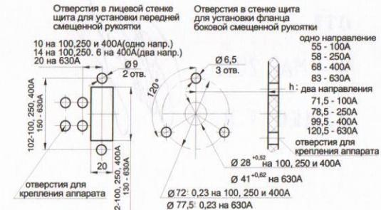
Рисунок В.2. Расположение отверстий в стекнах щита
